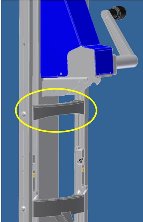
Wie auf der Skizze zu sehen, bohren Sie 2 Löcher mit dem angegebenen Abstand durch den Rahmen und setzen die Sprosse in dieser Position wieder ein
