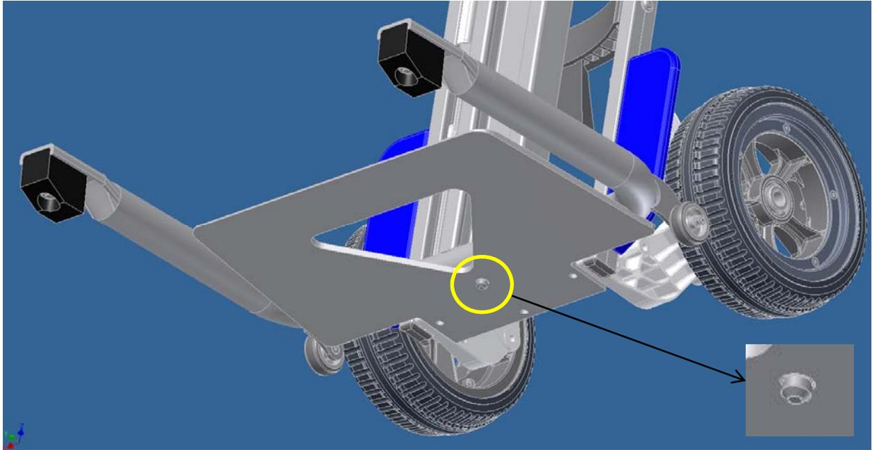
Bohren Sie ein Loch laut Skizze in die Schaufel, dies dient zur Positionsfixierung des Hubsystems
