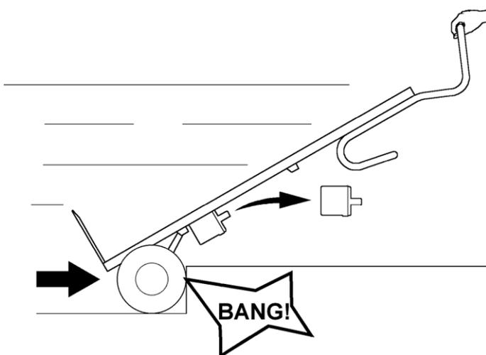
Der Akku sitzt eigentlich ziemlich fest in seinem Sitz. Zum Herausnehmen muss man ordentlich ziehen. Doch passiert es, dass der Akku herausspringt, wenn ziemlich schnell – meistens mit einem leeren Karren – angefahren wird. Die Wucht lässt den Akku herausspringen.
