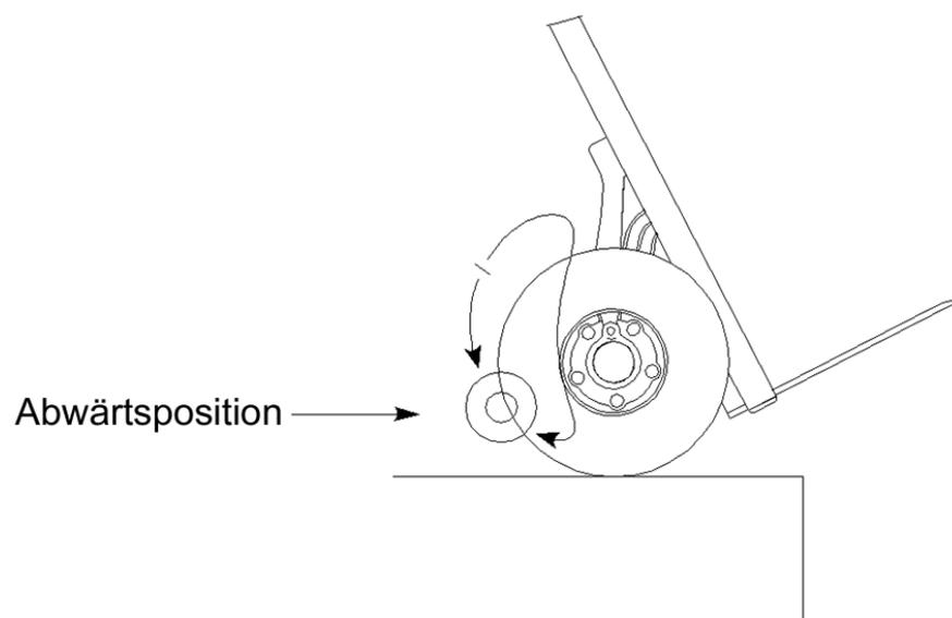
Jetzt können Sie die Stufe abfahren und der LIFTKAR senkt gebremst auf die nächste Stufe ab.
