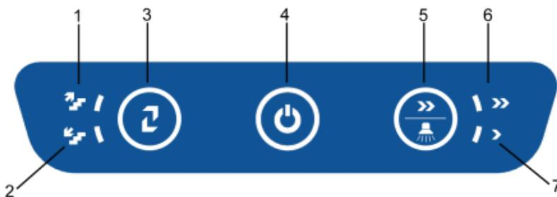
1: Anzeige Aufwärts - 2: Anzeige Abwärts - 3: Auf/Abwärts-Taster - 4: ON/OFF-Taster / Status-Anzeige - 5: Geschwindigkeitstaster / Treppenlicht - 6: Anzeige Geschwindigkeit schnell - 7: Anzeige Geschwindigkeit langsam
